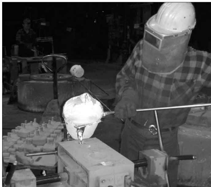
Zalanie formy metalowej (kokili) ciekłym aluminium.
